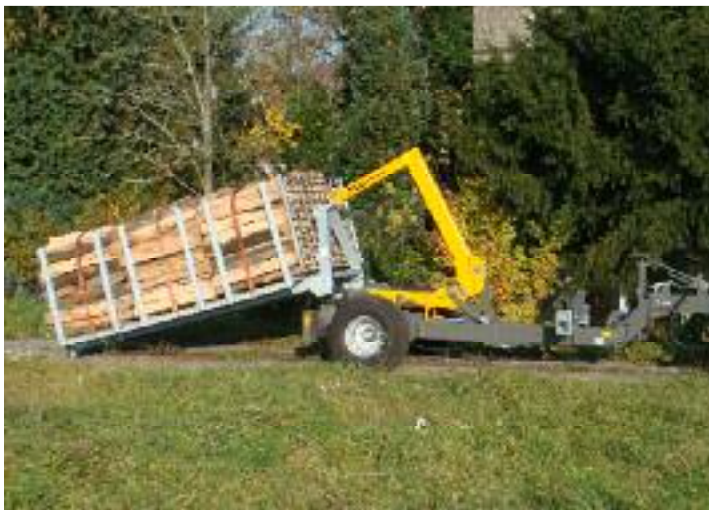
AR 54 beim Aufziehen einer Kurzholzplattform
