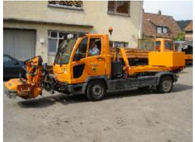
Auslegermähwerk mit Gegengewicht auf einem Maytec Grundrollrahmen
