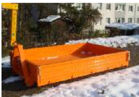
Bordwände aus rollgewalztem Stahlkipperprofil
