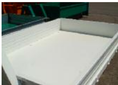
Boden aus Verschleißstahl, wie zum Beispiel „Hardox“
