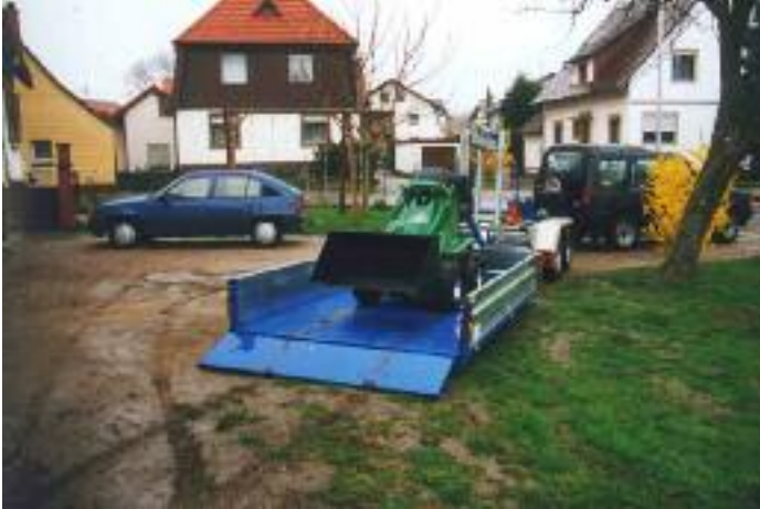
Befahrbare Heckklappe Standard – 400 mm befahrbar mit Ketten und Radfahrzeugen
