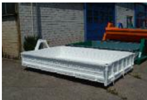
Bordwände aus rollgewalztem Stahlkipperprofil
