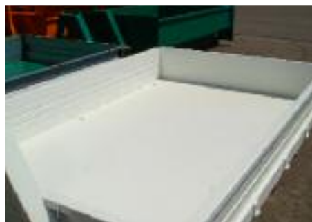
Boden aus Verschleißstahl, wie zum Beispiel „Hardox“
