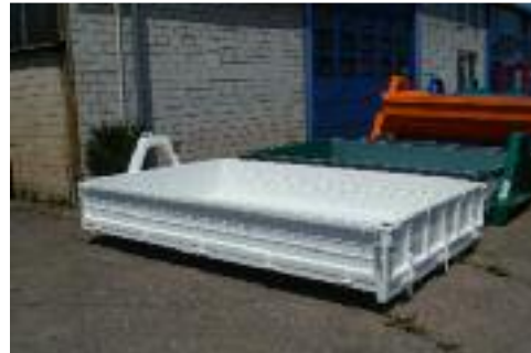
Bordwände aus rollgewalztem Stahlkipperprofil
