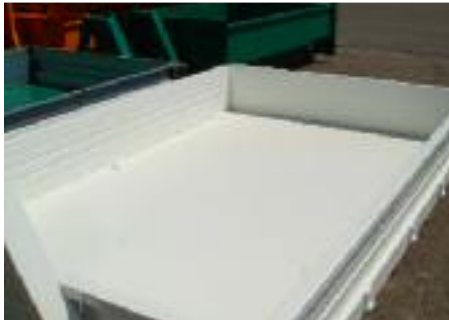
Boden aus Verschleißstahl, wie zum Beispiel „Hardox“
