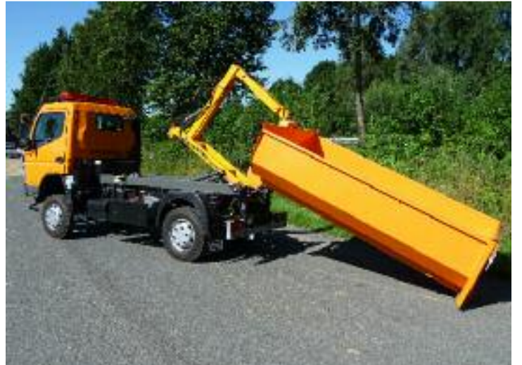
Der Maytec Abrollkipper bei den Bewegungen, die ihn den Namen gegeben haben: Abrollen/Kippen!
