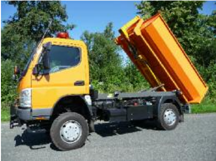
Der Maytec Abrollkipper bei den Bewegungen, die ihn den Namen gegeben haben: Abrollen/Kippen!
