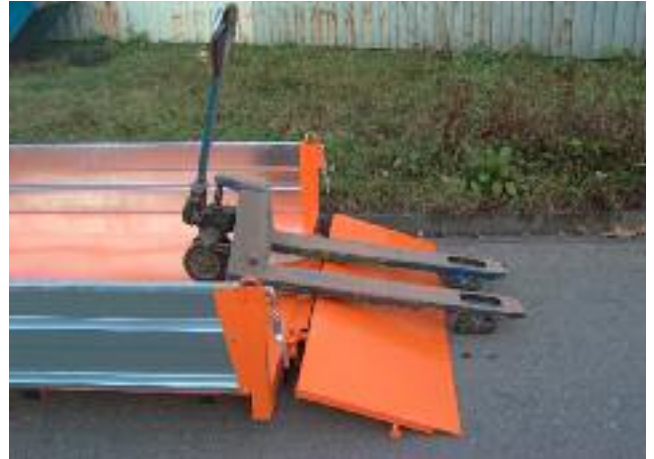
Befahrbare Heckklappe - hubwagenbefahrbar 600 mm hoch; Stahl
