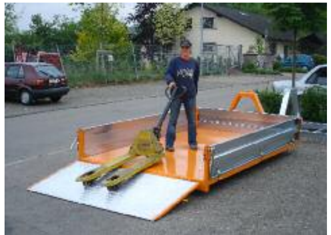
Noch flacher: Rampenlänge 800 mm; Träger aus Stahl, Fahrfläche aus Alu-Bodenprofilen
