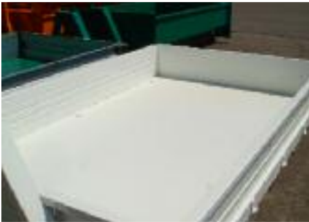
Boden aus Verschleißstahl, wie zum Beispiel „Hardox“
