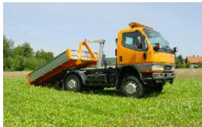
Pfau Rexter A7500 mit abgesenkter Hinterachse AR-L 55-2
