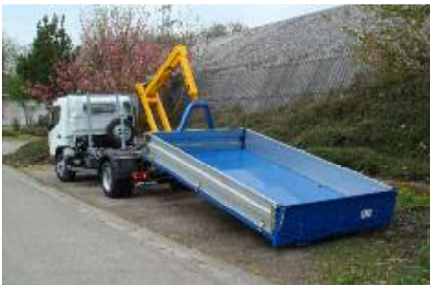
AR-L 55-3 auf dem Mitsubishi Fuso Canter mit Radstand 3350 mm
