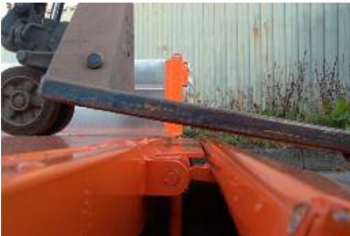
Hubwagenbefahrbare Heckklappen haben eine Füllung, damit die Räder nicht hängen bleiben
