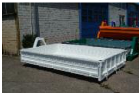
Bordwände aus rollgewalztem Stahlkipperprofil
